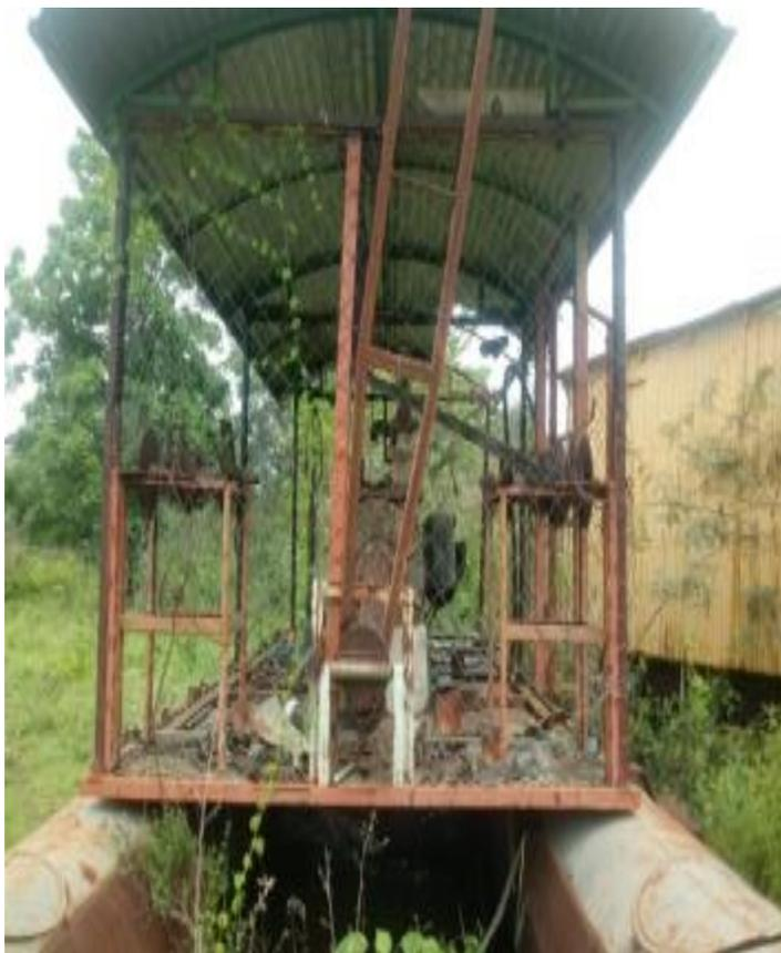
O equipamento encontra-se em péssimo estado de conservação devido a exposição as intempéries climáticas por guarda e exposição ao relento sem devida proteção, sem histórico de manutenção e sem registro de funcionamento, faltando motor, caixa de marcha.
